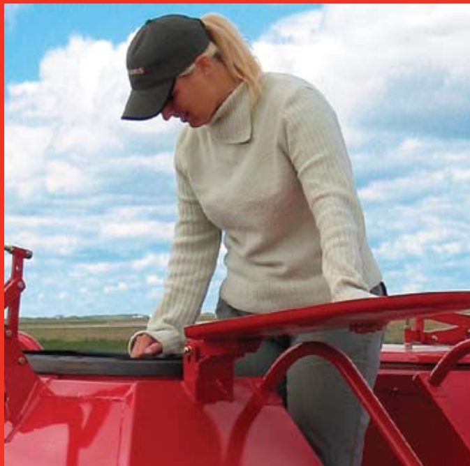
Проход между танками обеспечивает устойчивую площадку с крышками секций на уровне пояса.
