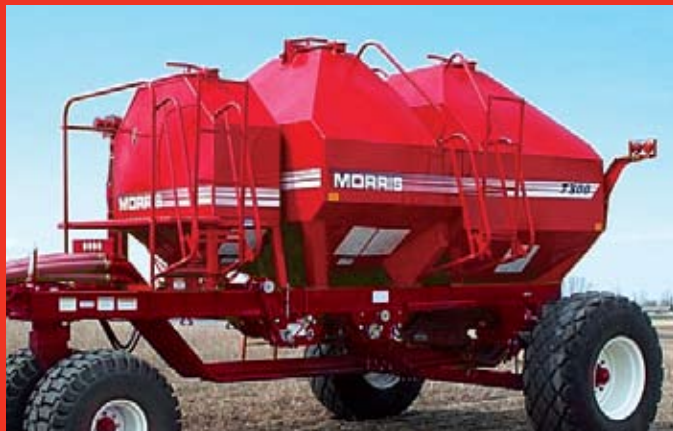
Проход между танками обеспечивает устойчивую площадку с крышками секций на уровне пояса.
