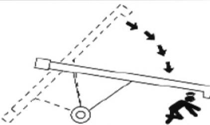
**FALLING CONVEYOR CAN CRUSH OR KILL!**
