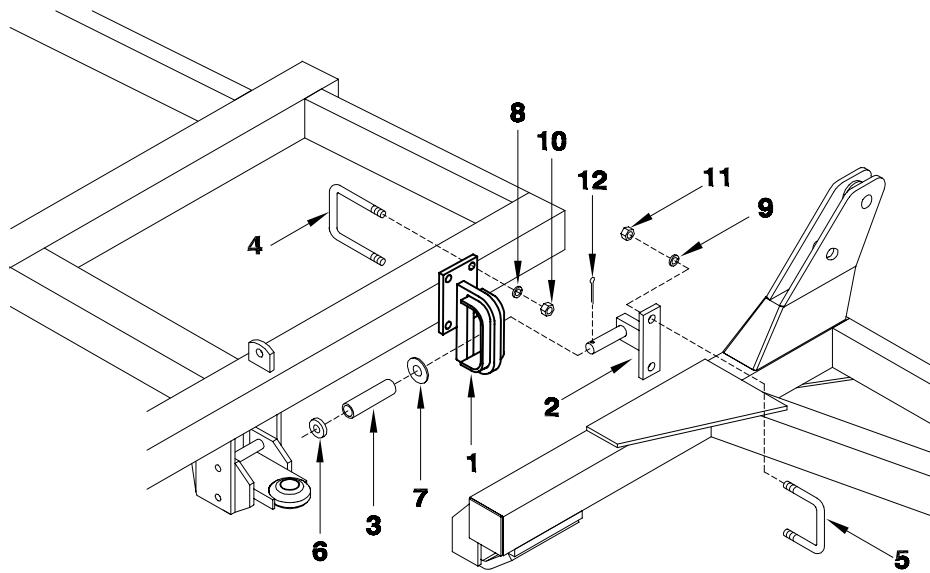
**ROLLER BRACKET - WELDED ON LUGS**
