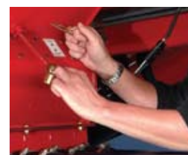
Перекрытия трех бункеров обеспечивают доступ к компонентам высевающего аппарата без необходимости опустошения бункера
