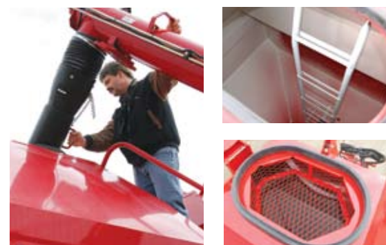
Увеличенные люки бункера, защищены решетчатыми сетками (стандарт), предотвращающими попадание мусора в бункер при наполнении.
