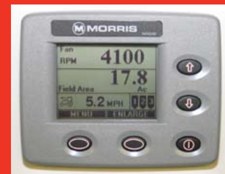
Монитор Vansco показывает скорость вращения вентилятора, скорость вращения вала дозатора, засеянную площадь, уровень загрузки резервуара и другую важную информацию.
