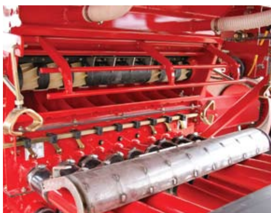
Высевающий аппарат из нержавеющей стали с быстросменными пластинами для крупных, мелких и средних семян, экономит Ваше время.
