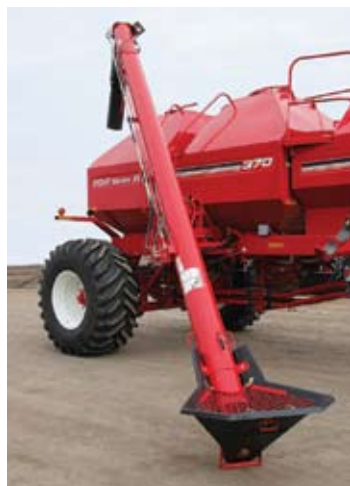
Верхние и нижние ручки контроля позволяют управлять процессом наполнения вверху или внизу.
